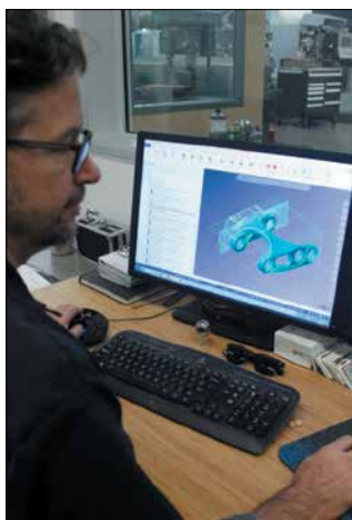
Andrew Schiffer программирует обработку звена подвески велосипеда Stumpjumper
