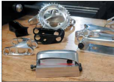
Заполняемая воском крепежная арматура тонкостенных деталей
