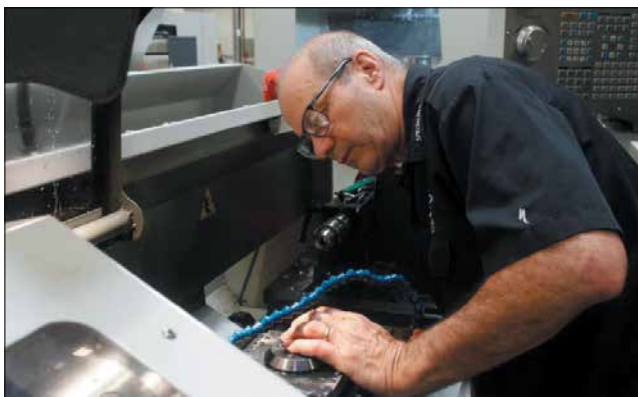
Bradford Craig проверяет правильность установки инструмента для обработки ступицы колеса на токарном станке TL1
