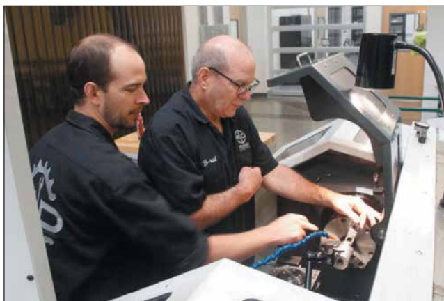
Bradford Craig и Daniel Lister готовятся обработать ступицу велосипедного колеса на токарном станке Haas TL1 Toolroom
