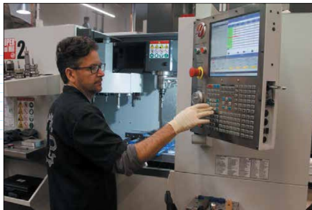
Andrew Schiffer готовит компактный станок Haas Super Mini Mill 2 для производства прототипов компонентов горного велосипеда Pedal Assist
