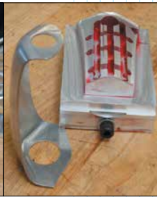
Заполняемая воском крепежная арматура тонкостенных деталей
