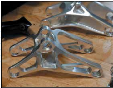
Звено подвески велосипеда для скоростного спуска S-Works Demo 8
