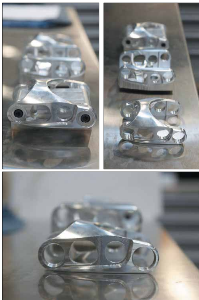
Деталь задней подвески велосипеда Stumpjumper на разных стадиях изготовления
