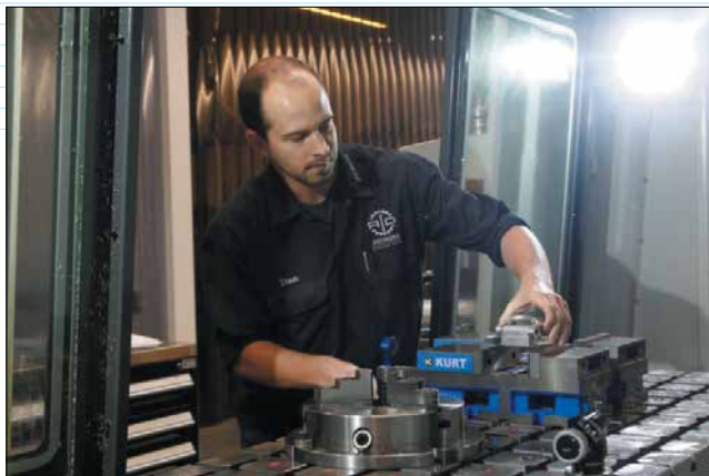
Daniel Lister устанавливает приспособление на вертикальном обрабатывающем центре Haas VM3 с ЧПУ
