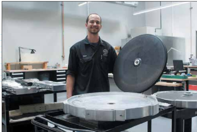
Daniel Lister с формой для изготовления колёс линейки Royal из углепластика
