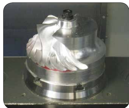
Рис. 8. Импеллер в процессе обработки на 5-осевом станке с ЧПУ
